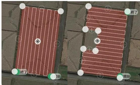
送信機（プロポ）の画面上で散布範囲を設定し、自動で散布幅 5m に合わせて登録可能。頂点を増やすことで変形圃場にも対応。登録は 1,000 圃場以上できるため上限を気にせず利用可能。
