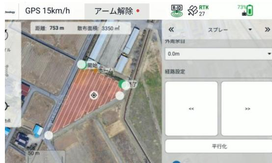
ルート設定のために圃場の周辺を歩いたり RTK 移動局の設置や設定も不要。固定基地局インターネット（Ntrip）方式対応。
