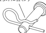
「スナップピン6」が「頭付ピン6×20」に正しく取付いた状態
